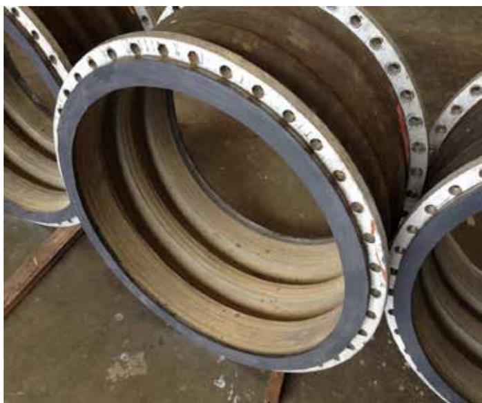
Belzona 2211 (MP Hi-Build Elastomer) es un compuesto de reparación elastomérico en pasta de dos componentes, diseñado para reparar y reconstruir piezas de goma.
